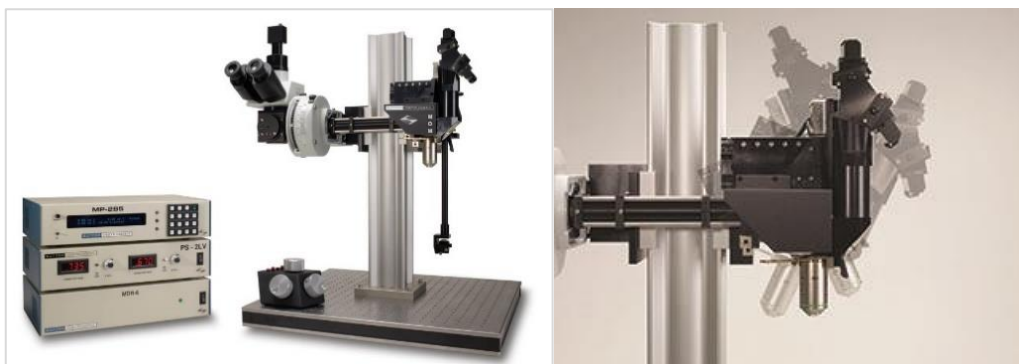
图 2.1 可移动物镜显微镜（MOM ® ）是一种双光子或三光子显微镜，当与适当的激光器组合使用时，能够对活体标本进行深层成像。Sutter MOM 是第一个能够 3 维移动和旋转的物镜，物镜沿 X, Y 和 Z 轴平移并绕 X 轴旋转。并且允许物镜通过旋转离开标准垂直位置自由定位至 0 到 180 度之间任意角度（如右图所示）。这种位置自由度允许对非水平表面和物体进行成像，无需移动台或其他方式干扰样品。即可在保持样品稳定的同时记录大范围，不同角度与深度的组织图像。（图片源自[2]）
